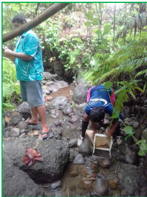
Photo 55 : prélèvement au filet « surber » dans le cours d'eau en entrée de tarodière
