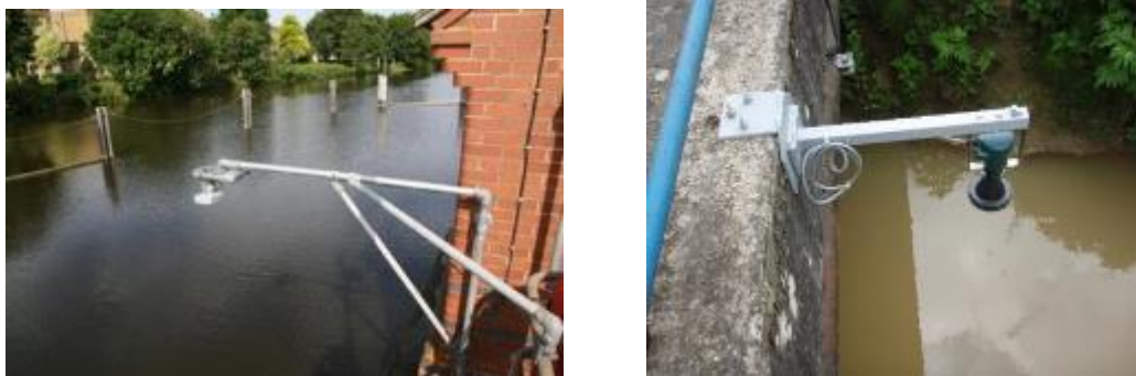
Figure 10 : Dispositifs de pose de radar (Exemple de potence amovible ou articulée)
