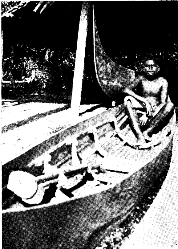
A gauche: L'intérieur d'une pirogue de Vella Lavella, en Nouvelle-Géorgie, avec les détails de la construction. On notera les pagaies en forme de feuille. Ci-dessus: Hangar aménagé spécialement pour les pirogues à haute proue. Vella Lavella, en Nouvelle-Géorgie.
