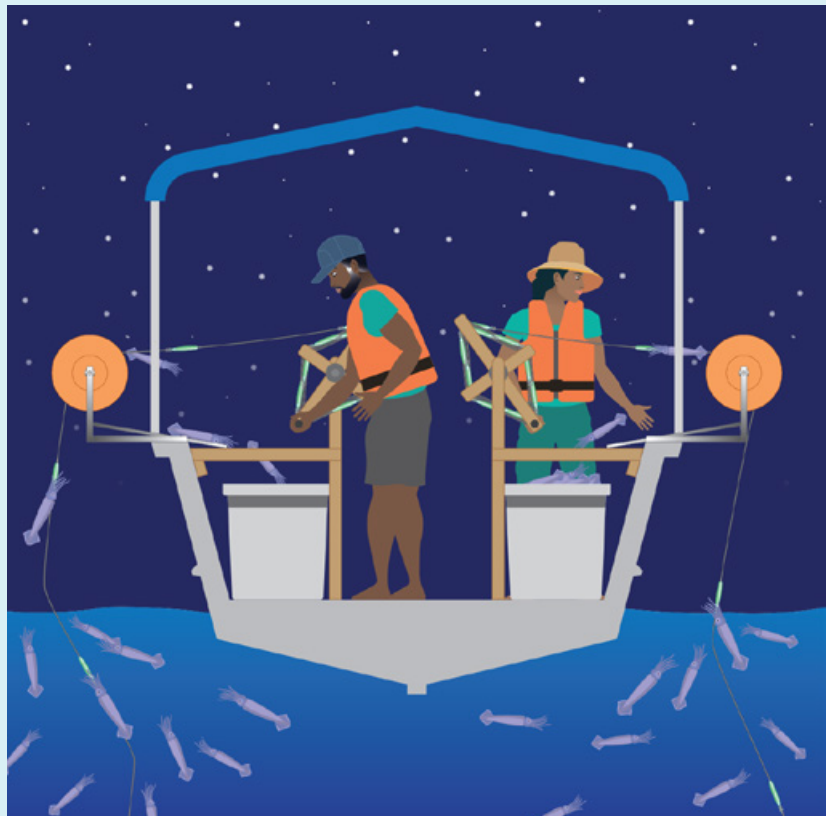
Configuration pour la pêche du calmar côtier à la turlutte sur un petit bateau, avec moulinets à main en bois de type FAO modifiés et rouleaux larges.
