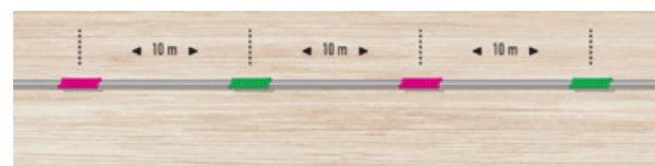
Il est possible de faire des surliures de fil dentaire à des intervalles déterminés, puis de les colorer pour indiquer la profondeur de la ligne.
