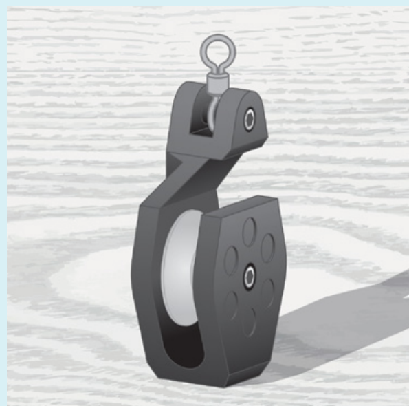
Une grande poulie ouverte est pratique pour filer une palangre verticale depuis un moulinet en bois.
