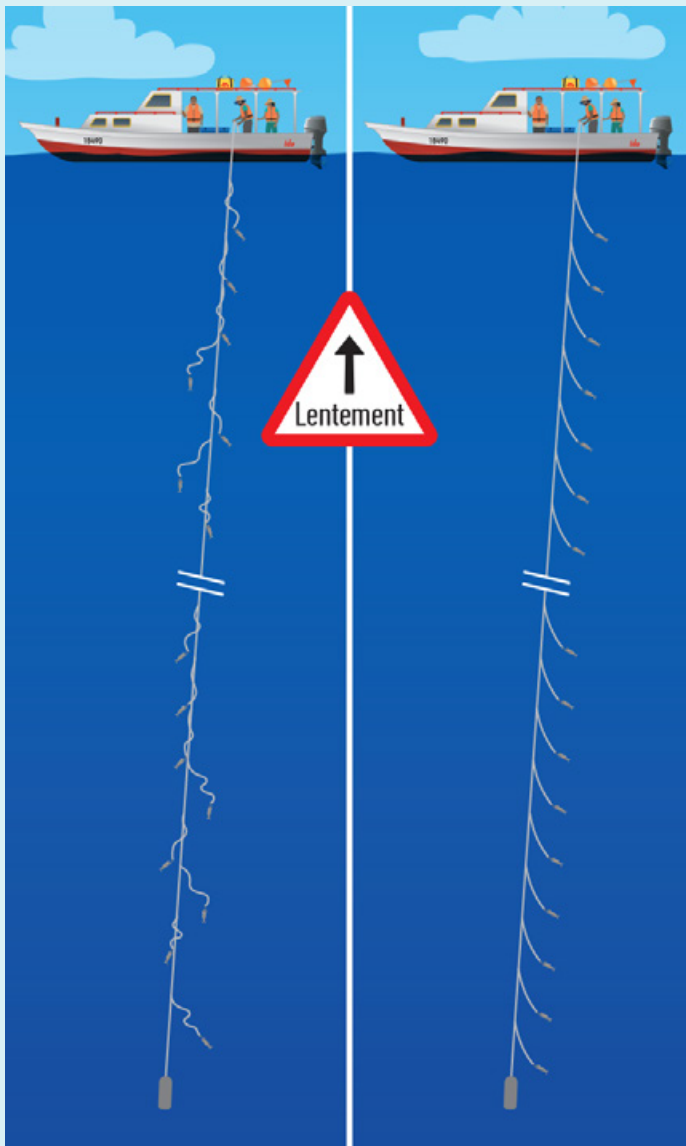
Si la palangre verticale est virée trop rapidement (à gauche), les avançons tendent à s'emmêler dans la ligne-mère.
