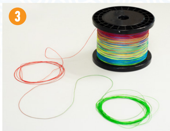
3 Tresse. C'est une ligne faite de plusieurs filaments tissés ensemble. Très souvent, une gaine tressée entoure une partie centrale (âme) faite de fibres. La tresse est très solide pour son diamètre et très peu élastique. La photo ci-dessus représente une tresse teinte d'une couleur différente tous les 10 m.
