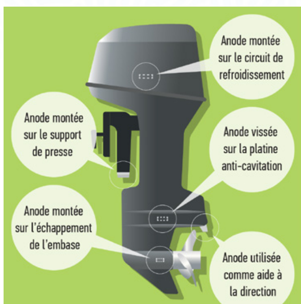
Certains moteurs hors-bord sont équipés de plusieurs anodes.
