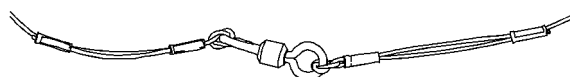
Émerillon McMahon serti dans un nylon monofilament plus fin à l'aide d'un œil à la Flamande
