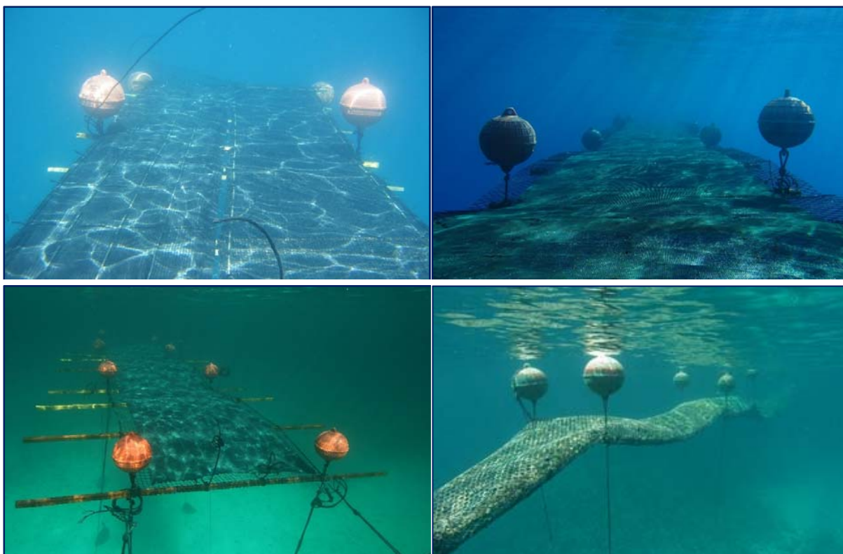
Figure 42 : (a) Station de collectage double en place (© L. Yan) - (b) Station simple en place (© C. Wabnitz) - (c) Station posée sur un site pas assez profond (© S. Andréfouët) - (d) Station avec grillage de protection (remarques : la station n'est pas assez tendue et les bouées trop en surface) (© L. Yan)
