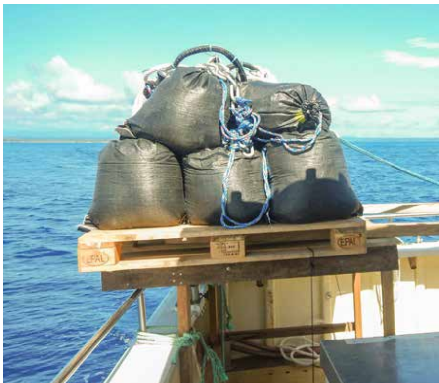
Photographie 7 : corps-mort fabriqué à l'aide de sacs de sable.
