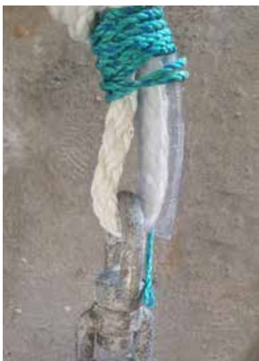
Photographie 1 : gaine en plastique qui n'a pas été correctement installée.
