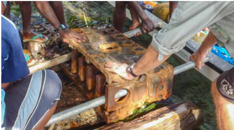
Photographie 6 : corps-mort fabriqué à partir d'un bloc-moteur de récupération.
