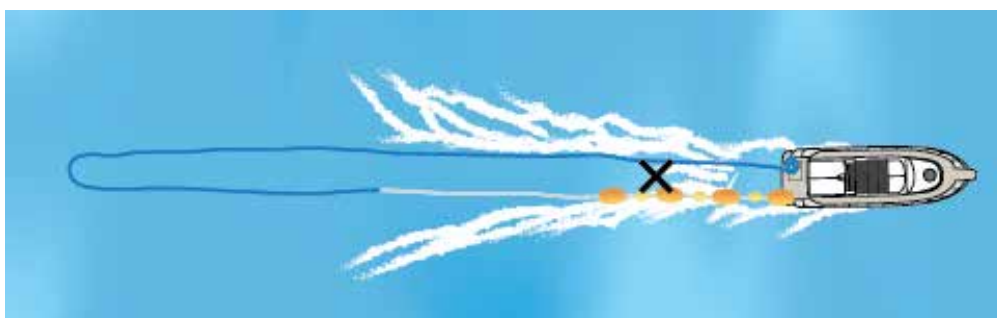
Figure 33 : technique de mise à l'eau des DCP immergés et lézards. La croix (X) désigne la position finale souhaitée pour le corps-mort.
