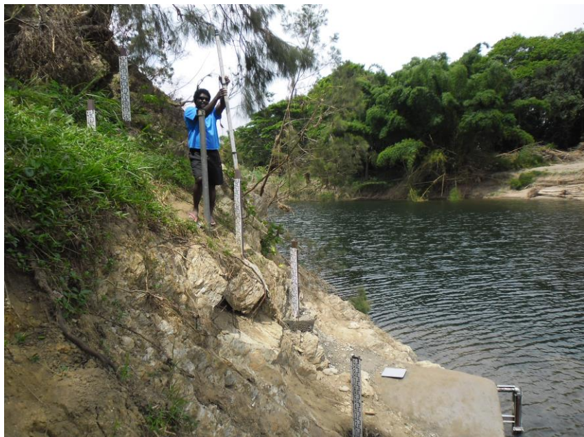
Figure 32 Exemple d'implantation de batterie d'échelle, source DAVAR
