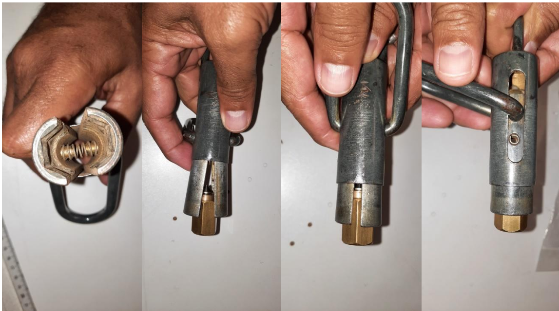
Figure 12 Fonctionnement Erou / clé DTG, source DAVAR
